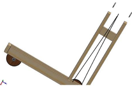
Figuur 4: Draai de schroefgaten recht tegenover elkaar boven in de twee verticale lange latten.
